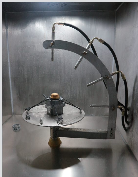
Gehäuse bei IPx9k-Test
